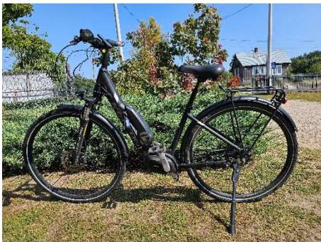
Ausgestattet mit 8-Gang-Nabenschaltung und V-Bremse (auf Anfrage). Bei den Elektrorädern (Pedelects) beachten Sie bitte, dass die Unterstützung des Motors nur zusätzlich zum Treten kommt. Eine Akkuladung reicht für eine Strecke von ca. 70-90 km, je nachdem welche Unterstützung-Stufe verwendet wird (Eco, Sport, Turbo).
