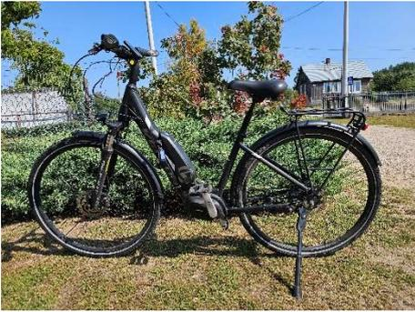
Ausgestattet mit 8-Gang-Nabenschaltung und V-Bremse (auf Anfrage). Bei den Elektrorädern (Pedelecs) beachten Sie bitte, dass die Unterstützung des Motors nur zusätzlich zum Treten kommt. Eine Akkuladung reicht für eine Strecke von ca. 70-90 km, je nachdem welche Unterstützung-Stufe verwendet wird (Eco, Sport, Turbo).
